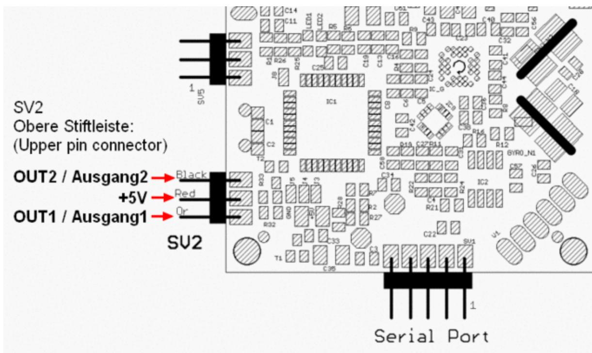
Sorties (rangée supérieure du connecteur SV2) de la [FlightCtrl](#). Le contact est une mise à la masse!
