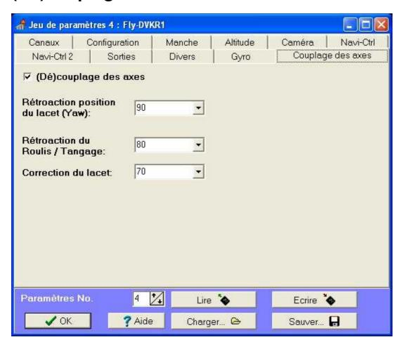
Il y a une interaction entre le lacet, le tangage et le roulis. Une action sur deux d'entre eux, induit une modification du troisième. Le MK sortira donc incliné d'une courbe compensée en roulis, cette fonction empêche cela.
