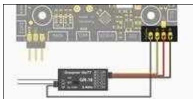
(Anschluss an FlightCtrl V3.0)
