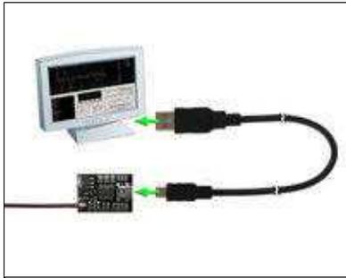
Das **Wi.232-PC** wird über das USB-Anschlusskabel mit dem PC verbunden.
