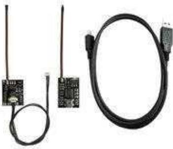
Das **MK WI232 Set** ist eine drahtlose serielle Funkübertragung zwischen dem [MikroKopter](#) und dem Computer.
