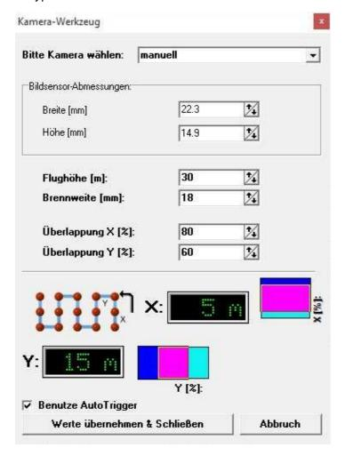
• Nun kann die Flughöhe, die verwendete Brennweite und die gewünschte Überlappung in X und Y Richtung eingetragen werden.
