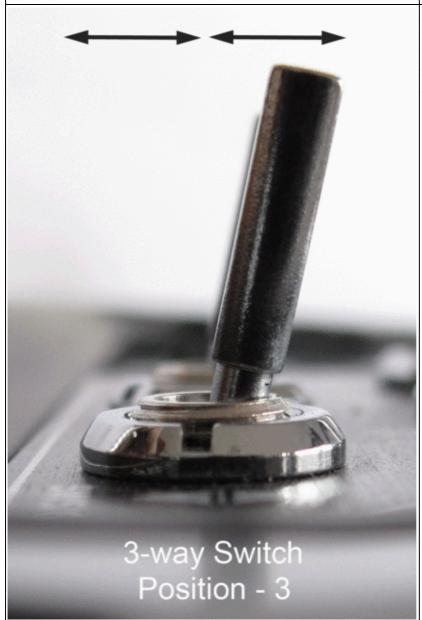
Schalterstellung 3 = An (254) Kamera wird manuell ausgelöst
