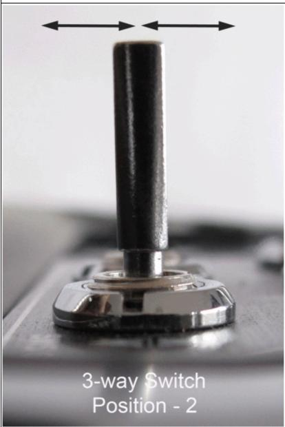
Schalterstellung 2 = Automatik (126) Kamera wird beim WP-Event automatisch ausgelöst
