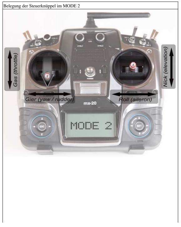
Beschreibung der Steuerknüppelstellungen für MODE 2 Kalibrieren des ACC (Einmalig Funktion => nötig. Der Kopter muss dazu gerade stehen.) Beschreibung der Gas oben / Steuerknüppelstellung Gier rechts / Nick mitte / => Roll mitte
