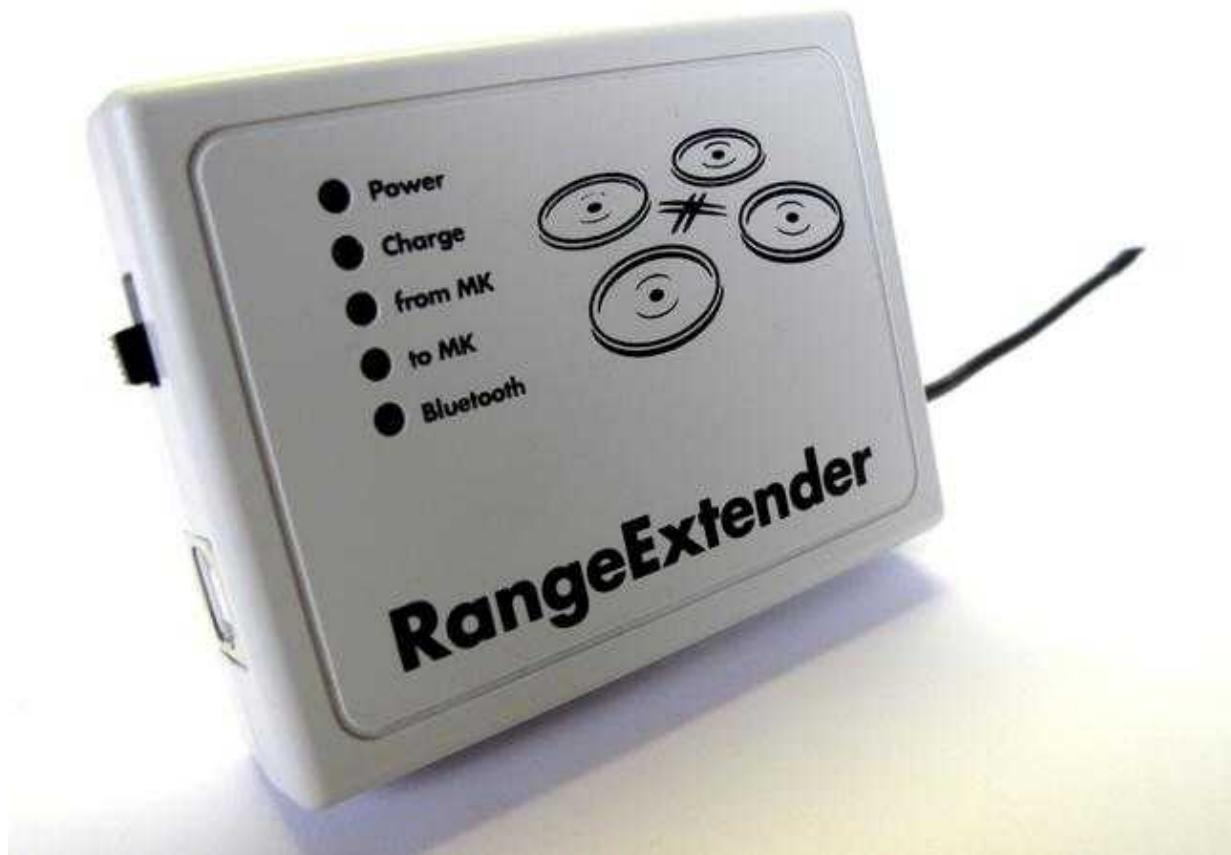
Mit dem RangeExtender kann eine drahtlose Verbindung zum MikroKopter über eine große Reichweite hergestellt werden (>1000mtr).
