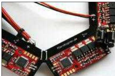
Batteriekabel: Silikonleitung ca. 15cm  $2,5\text{mm}^2$
