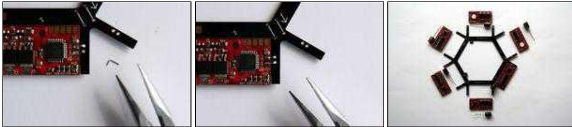
Die Silberdraht "Winkel" werden in die Löcher der Verteilerplatine gesteckt, positioniert und eingelötet. Anschließend werden die Drahtenden an die "C" und "D" Anschlüsse der BL-Regler angelötet.
