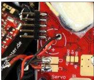
= Montage der FC = Auf die Gewinde der Schwingungsdämpfer kann man noch Kunststoffmuttern schrauben, damit die FC 3mm höher kommt. Anschließend wird die FC auf die Schwingungsdämpfer aufgesteckt und die FC so montiert, dass der kleine Pfeil nach vorne zeigt und mit vier 15mm-Abstandsbolzen festgeschraubt.
