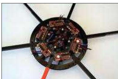
**⚠ Achtung:** Die 10mm Abstandsbolzen auf denen die BL-Ctrl's fest geschraubt werden, müssen so gedreht werden, dass die Abstandsbolzen voll auf der Platine der jeweiligen BL-Ctrl aufliegen und den SMD-Kondensator C7 nicht einklemmen!
