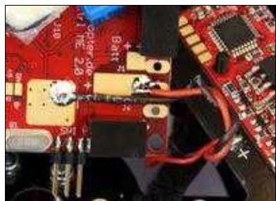
Plus muss hinter dem Schalter angeschlossen werden, weil der Schalter bei dem Hexa nicht bestückt wird (befindet sich auch nicht im Lieferumfang).
