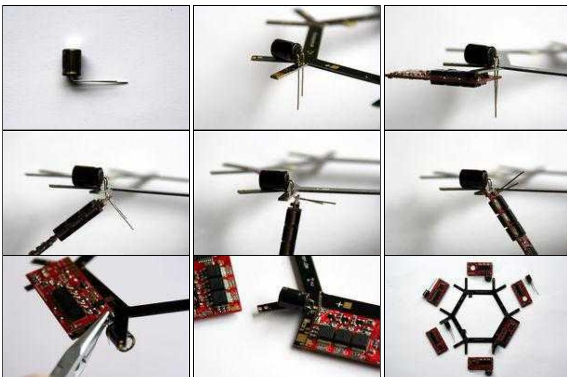
⚠ Alle Elkos müssen sorgfältig und mit viel Hitze an den Verteiler angelötet werden, ansonsten entsteht hier schnell eine kalte Lötstelle. Die Verteilerplatine ist mit 70µm Kupfer belegt, sodass mehr Hitze zu den Seiten abgeführt wird.
