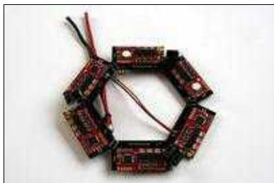
**HINWEIS:** Bei Verwendung des Molex-Kabels für die Verbindung der [FlightCtrl](#) mit der Verteilerplatine kann die separate Verkabelung der FC Versorgung, der I2C und des Summers entfallen.
