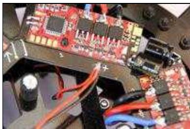
An diese +/- Anschlüsse der Verteilerplatine werden die Anschlußkabel des LED-Streifens vom Ausleger hinten links und hinten rechts polrichtig angelötet.
