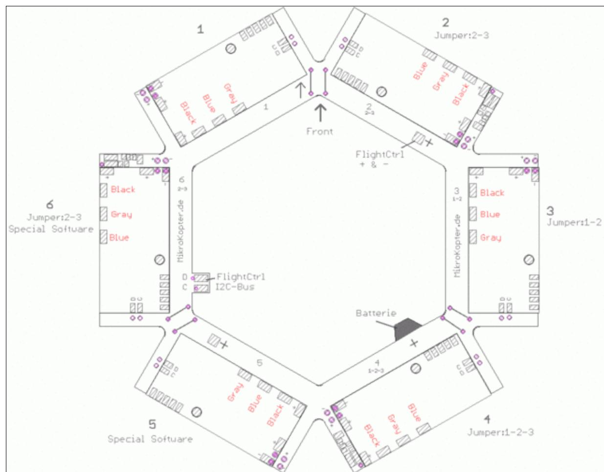
Die BL-Regler werden wie hier dargestellt in der Verteilerplatine angeordnet.
