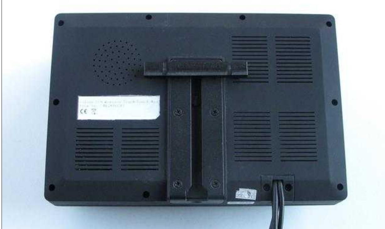
Dann wird der untere Halter von unten eingeschoben.
