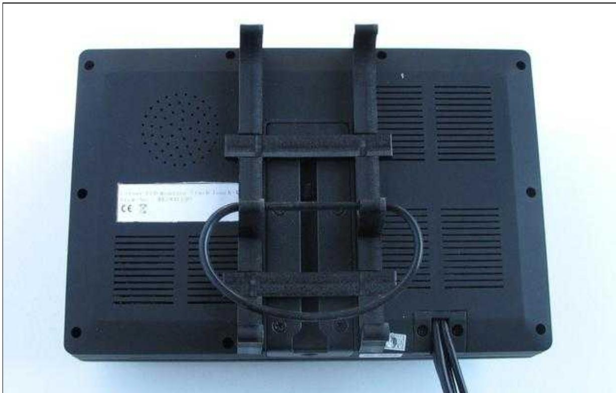
Jetzt kann der Empfänger mit der Unterseite voran, in den Halter gedrückt und der Lipo mit dem Gummiring fixiert werden.
