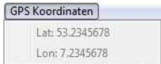
In dieser Ansicht wird die aktuelle Position des MikroKopter mit Längen- und Breitengrad in Dezimalgrad angezeigt.
