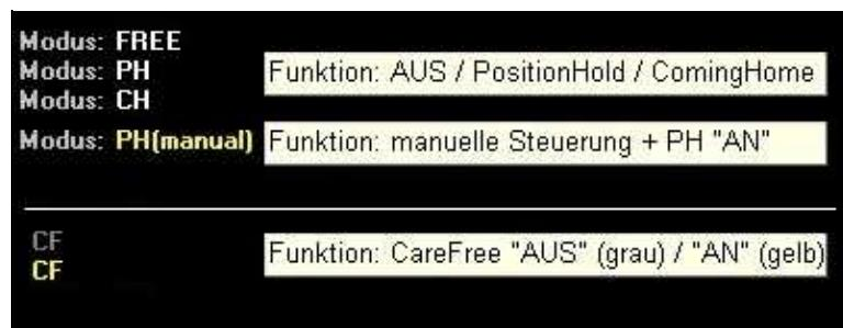
Die Anzeige **PH(manual)** wird angezeigt, wenn die Funktion **PositionHold** aktiviert ist und der Kopter dabei manuell geflogen wird.
