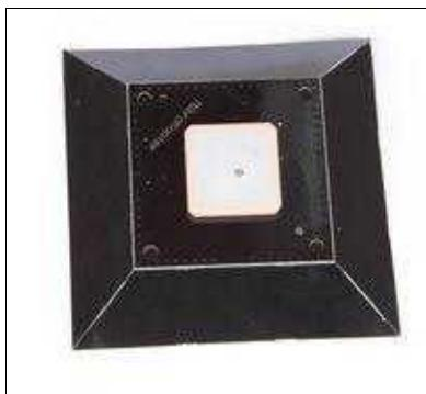
Hierbei handelt es sich um eine Vergrösserung der MKGPS-Massefläche, um den GPS-Empfang zu verbessern. Zudem schirmt es die elektromagnetischen Störungen der restlichen Elektronik sehr gut ab.
