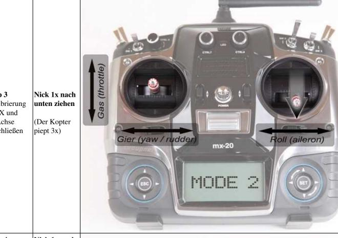
Step 3 Kalibrierung der X und Y-Achse abschließen
