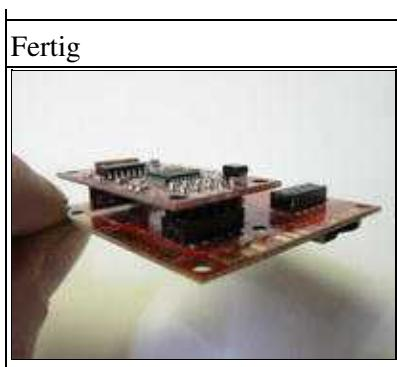
**⚠ Einbau:** Die mechanische Befestigung beachten! Das MK3Mag sollte mit den zwei mitgelieferten Kunststoffschrauben richtig befestigt werden. Ansonsten könnte sich der MK3Mag im Flug lösen und Wackelkontakte verursachen. Hierdurch können dann Fehler wie z.B. plötzlicher Richtungsverlust, Fehler bei "PH" oder "CH", etc. auftreten.
