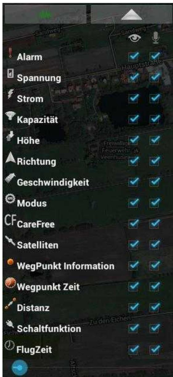
Auf der linken Seite befindet sich die Auswahl der anzuzeigenden / zu sprechenden Telemetriedaten des MikroKopter.
