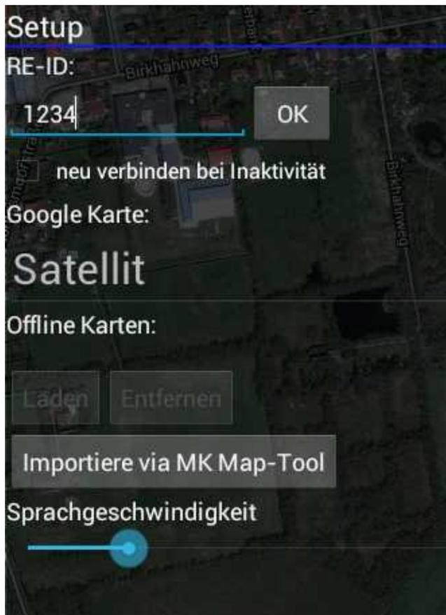
Im rechten Fenster wird die Anzeigeform der Google Map ausgewählt, gespeicherte Karten geladen und der [RangeExtender](#) im Programm angemeldet werden.
