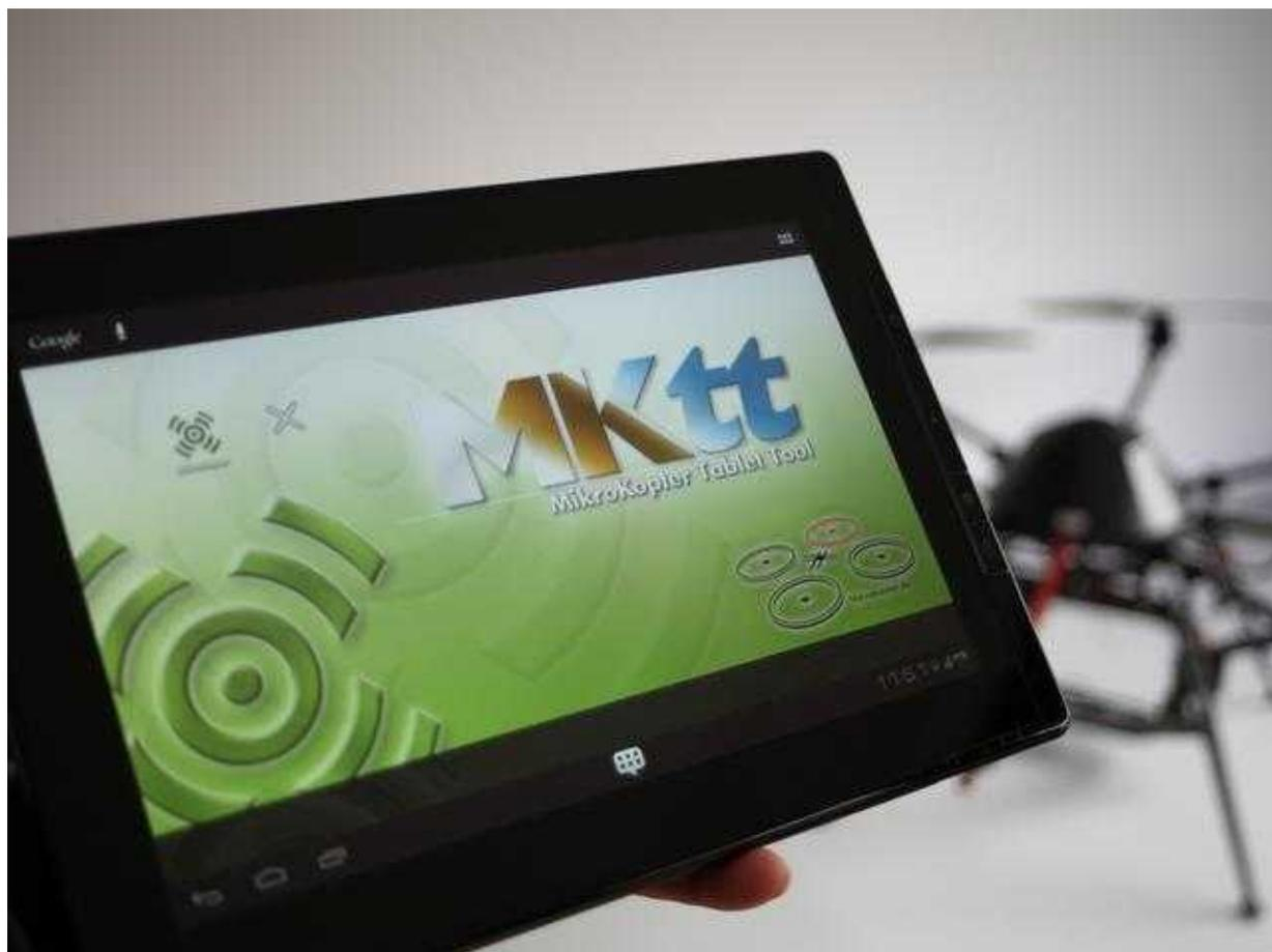
Das MikroKopter-Tablet Tool (kurz MK-TT) ist eine Android-APP, mit dem Wegpunkte und/oder POI sehr einfach und intuitiv in einer Karte (Map) gesetzt und an den Kopter übertragen werden kann. Während des Fluges kann der Kopter dabei auf dieser Karte verfolgt werden und es können auch zusätzlich neue Wegpunkte während des Fluges zum Kopter hin übertragen werden.
