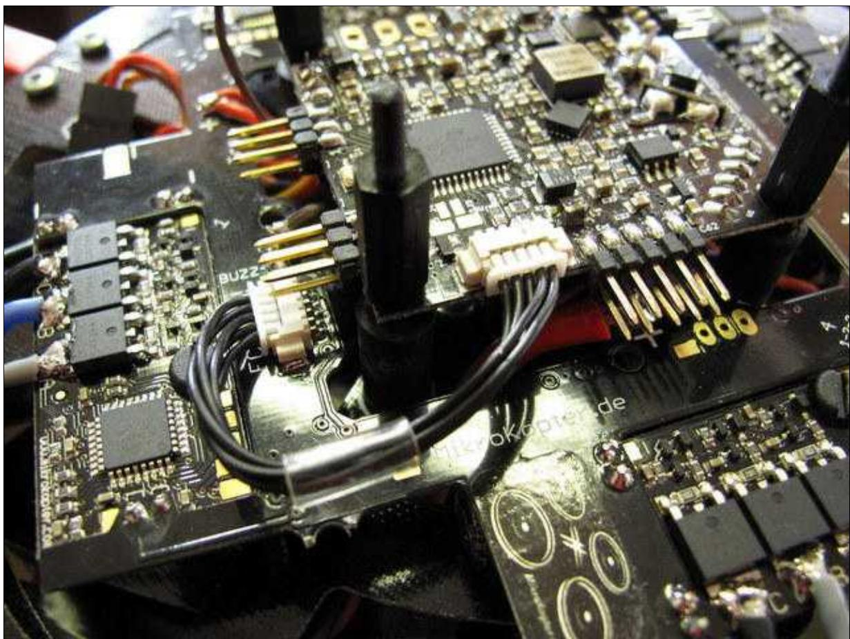
⚠ Die [FlightCtrl](#) muss mit dem aufgedrucktem Pfeil zum Ausleger Nr.1 (roter Ausleger) zeigen!
