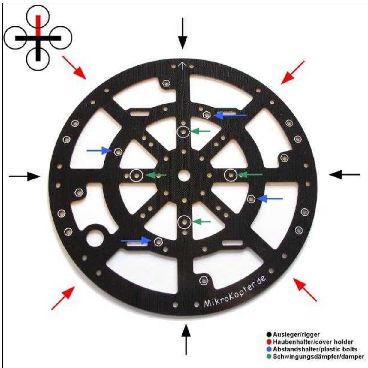
An die obere Centerplate werden zuerst die vier Abstandshalter (M3x8 oder M3x10) montiert. Hieran wird später der Stromverteiler angeschraubt. Die vier Abstandshalter werden mit dem Gewinde durch die Centerplate gesteckt und von unten mit einer Mutter gesichert.
