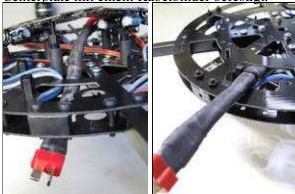
Nachdem der Stromverteiler an die vier Abstandshalter geschraubt wurde, kann mit dem Auflöten der Motorkabel begonnen werden. Das Ergebnis sieht so aus:
