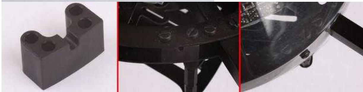
⚠ Die Haube sollte von innen in einer beliebigen Farbe lackiert werden. Hierdurch werden Fehlfunktionen durch Sonnenstrahlen auf den lichtempfindlichen Höhensensor verhindert.
