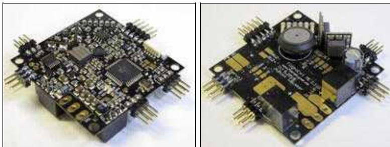
Die FC V2.1 kann mit einem 5pol. Molex-Kabel an den Stromverteiler angeschlossen werden.
