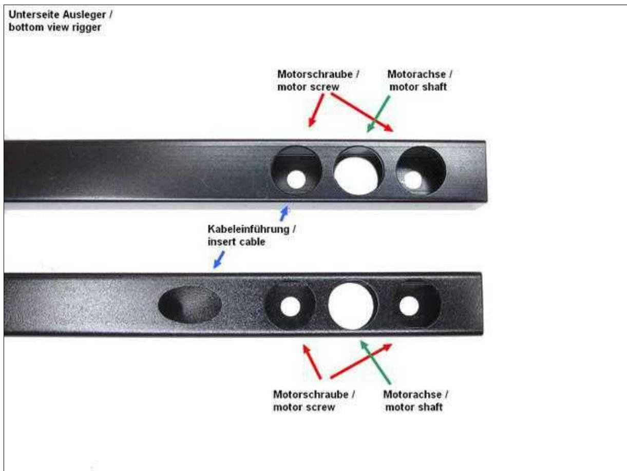
**⚠** Die Motorkabel werden bei den aktuell ausgelieferten Sets auf der linken Seite der Ausleger (ovales Loch) herausgeführt! (Vom Mittelpunkt der Centerplate aus gesehen.)
