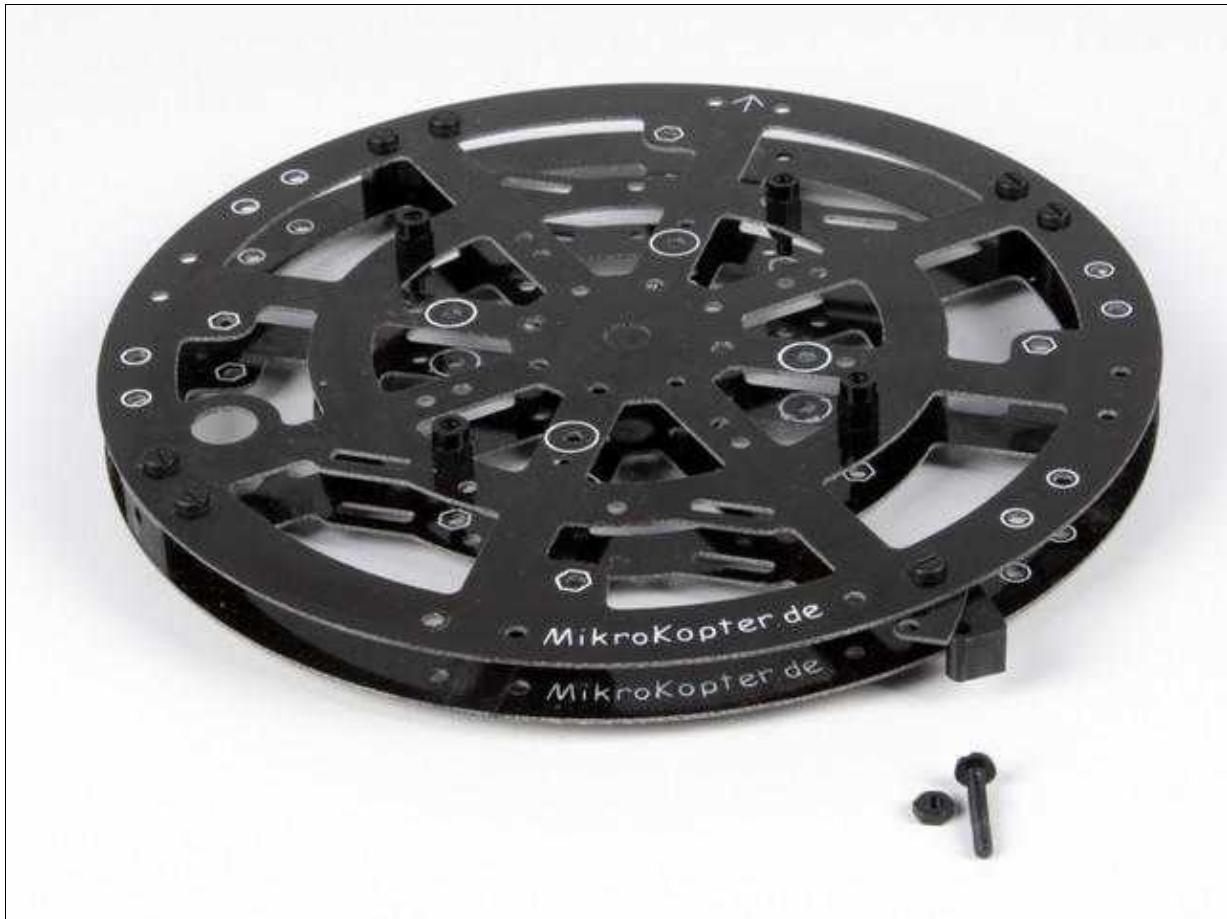
Jetzt können die Ausleger montiert werden. Diese werden mit einer Metallschraube in der Mitte der Centerplate angeschraubt. Eine zweite Metallschraube wird von unten durchgesteckt und mit dem Gummidämpfer (M3x15) befestigt. Hieran wird später die [FlightCtrl](#) befestigt. Auf die Gummidämpfer wird noch je eine M3 Kunststoffmutter **oder** ein Abstandshalter (M3x10) geschraubt um der [FlightCtrl](#) noch ein wenig mehr Abstand zu geben.
