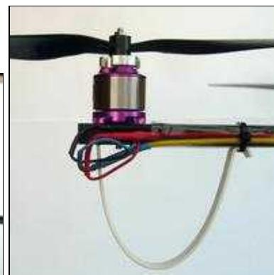
Die Motorleitungen der Motoren können außen oder durch die Ausleger verlegt werden. Bei dem Heckausleger kann man gleichzeitig die Leitungen für den Summerverlegen und den Summer dann mit Schrumpfschlauch am Ausleger befestigen.
