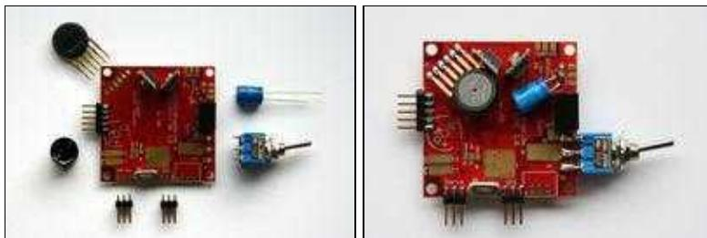
Die [FlightCtrl](#) ist die Hauptplatine vom [MikroKopter](#). Auf ihr befinden sich sämtliche Sensoren, die zum Fliegen erforderlich sind ([GyroScope](#), [BeschleunigungsSensor](#) und [LuftdruckSensor](#)), sowie der Mikrocontroller.
