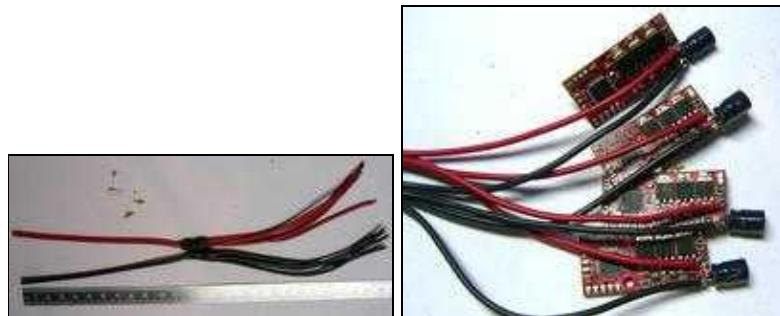
Man fertigt den Kabelbaum aus einer dicken Zuleitung (ca. 10cm), an der vier Abgangsleitungen angelötet werden (ca. 12cm). Die Lötstelle muss mit viel Lötzinn versehen werden. Anschließend wird die Lötstelle mit Schrumpfschlauch oder Isolierband isoliert. Anmerkung: Wenn man die Brushless-Controller lieber an den vier Auslegern montieren möchte, sind die angegebenen 12cm etwas zu kurz!
