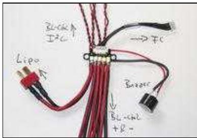
Hinweis dazu: Wenn die [FlightControl](#) über das Molex-Kabel am Miniverteiler angeschlossen wird, kann sie **nicht über Ihren Schalter geschaltet** werden. Sie wird automatisch versorgt, sobald Spannung an dem Verteiler angeschlossen ist
