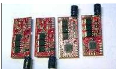
Im Gegensatz zu herkömmlichen BL-Reglern verfügt sie über einen schnellen Datenbus zur FC (I2C) und setzt die Motorsollwerte spontan um. Herkömmliche BL-Regler können nicht verwendet werden.
