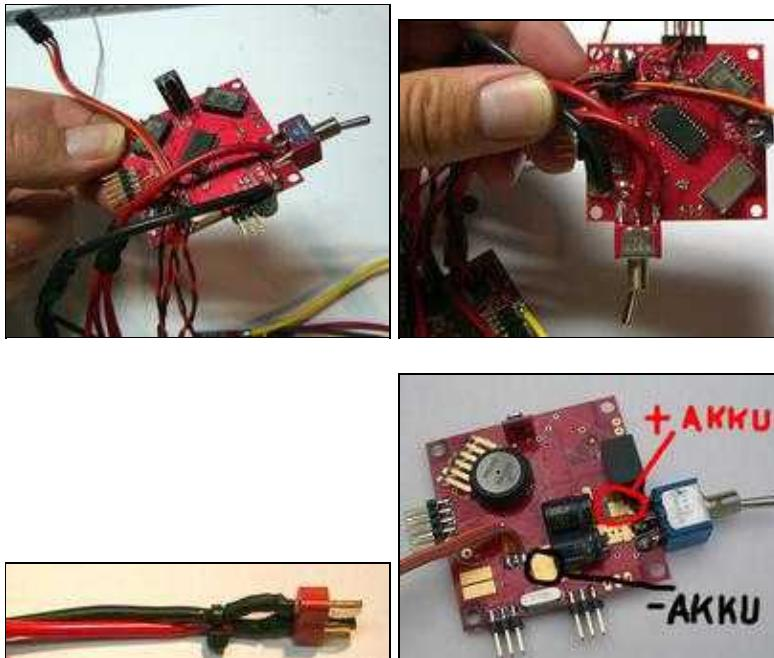
Das Batteriekabel besteht aus dem männlichen Batteriestecker (Bezeichnung: [DEANS](#)) (ist mit + und - beschriftet) und ca. 15cm langem Anschlusskabel. Die Kontakte am Batteriestecker müssen mit Schrumpfschlauch gegen Kurzschluss gesichert werden.
