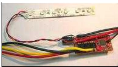
Die Leuchtbänder werden mit 12V versorgt. Am einfachsten ist es, wenn man sie mit einer dünnen Leitung an die Versorgung des vorderen Reglers (Nummer 1) anschließt. Hier reichen 4-5cm Leitungslänge. Das LED-Band vom Basisset mit den 6 LEDs kann man bei Bedarf in der Mitte auseinanderschneiden und unabhängig voneinander mit 12 Volt versorgen.
