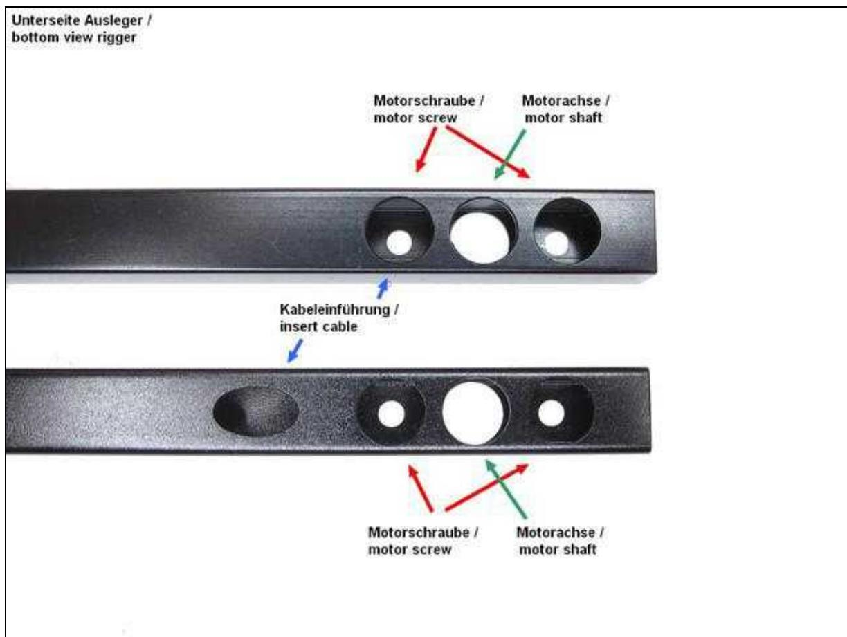
**⚠** Die Kabel werden auf der linken Seite der Ausleger (ovales Loch) wieder herausgeführt! (Vom Mittelpunkt der Centerplate aus gesehen.)
