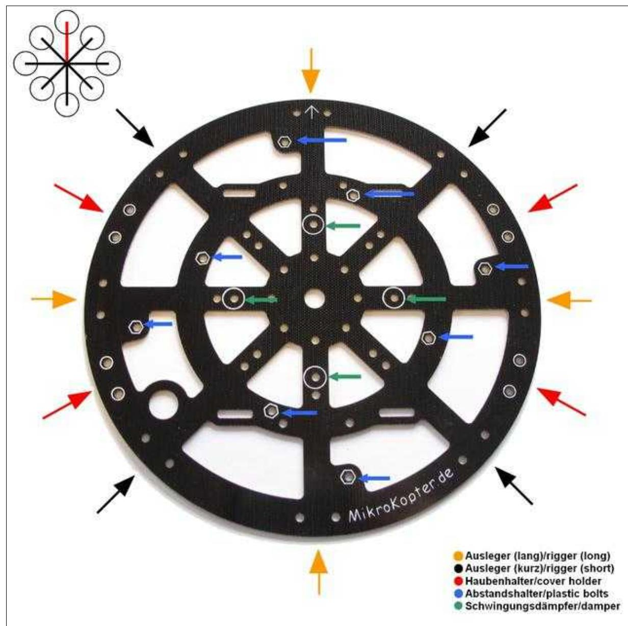
An die obere Centerplate werden zuerst die acht Abstandshalter (M3x10) montiert. Hieran wird später der Stromverteiler angeschraubt. Die acht Abstandshalter werden mit dem Gewinde durch die Centerplate gesteckt und von unten mit einer Mutter gesichert.
