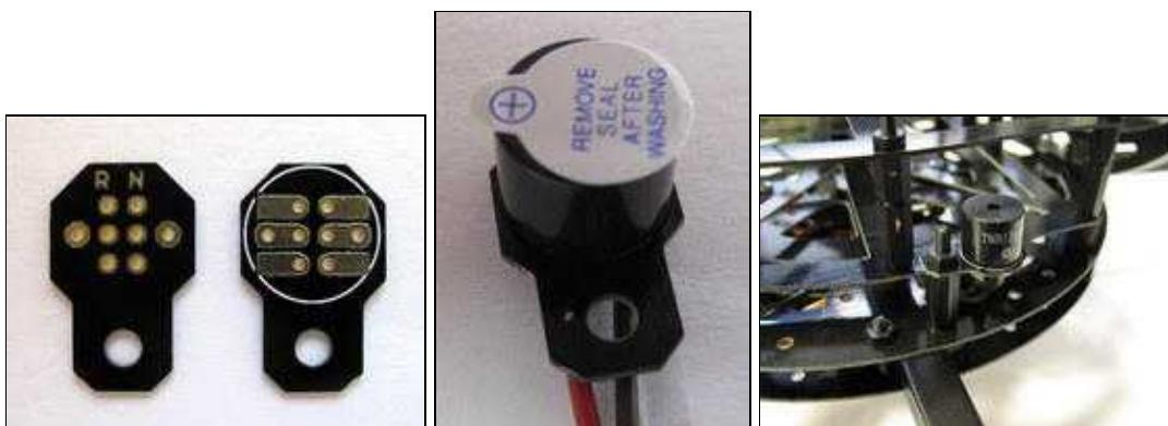
Die Adapterplatine incl. Summer kann mit einem 15mm Abstandshalter an der Centerplate montiert werden. Der Halter sollte nicht am Lipo-Halter befestigt werden. Im Falle eines Crashes könnte das das Kabel zum Summer abreißen.
