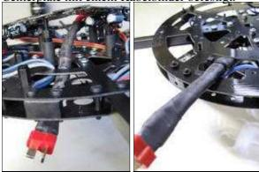
Nachdem das Powerboard mit den 8 Kunststoffschrauben (M3x8) an die acht Abstandshalter geschraubt wurde, kann mit dem Auflöten der Motorkabel begonnen werden. Das Ergebnis sieht so aus:
