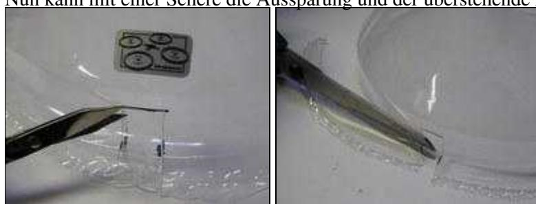
Die Haube kann dann aufgesteckt und mit einer Schraube gesichert werden. Hierzu kann z.B. mit einem 2mm Bohrer ein Loch durch die Haube und den Haubenthalter gebohrt werden.
