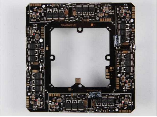
• Die Elkos für die Regler 6 und 8 können an der Unterseite des Verteilers befestigt werden. Hierdurch können bei Verwendung der NaviCtrl, die 10+6 Poligen Verbindungsstecker einfacher gesteckt werden.
