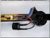
Zuerst wird die LED-Leiste mit Schrumpfschlauch eingeschrumpft, danach der Summer
