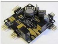
Die FC V2.1 kann mit einem 5pol. Molex-Kabel an den Stromverteiler angeschlossen werden.
