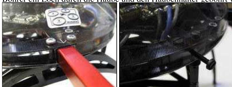
Wird die neue Version des Haubenhalters genutzt ist hier bereits eine Aussparung für die Schraube vorgesehen. Hier kann die Schraube direkt durch die Haube in die Aussparung geschraubt werden.
