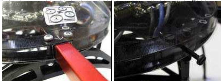
Wird die neue Version des Haubenthalters genutzt ist hier bereits eine Aussparung für die Schraube vorgesehen. Hier kann die Schraube direkt durch die Haube in die Aussparung geschraubt werden.
