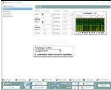
Ist der MikroKopter mit dem Computer verbunden und das [KopterTool](#) gestartet, kann man in den Einstellungen (Reiter "Kanäle") die Kanaluordnung überprüfen. Wird ein Geber am Sender betätigt, kann man den Ausschlag des dazu eingestellten Kanal beobachtet.
