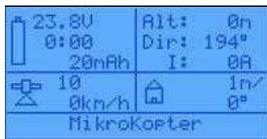
Über das obere Display an der Fernsteuerung kann die MikroKopter-Telemetrie angezeigt werden. Hier lassen sich folgende Werte ablesen:
