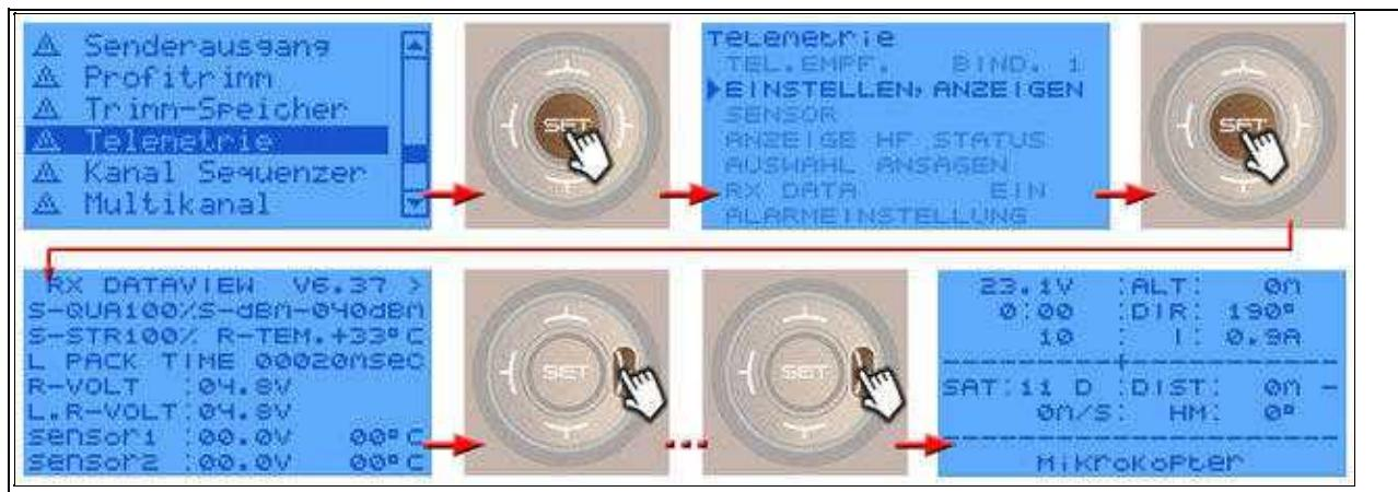
Ist man in der Text-Telemetrie, können weitere Unterfenster geöffnet werden.
