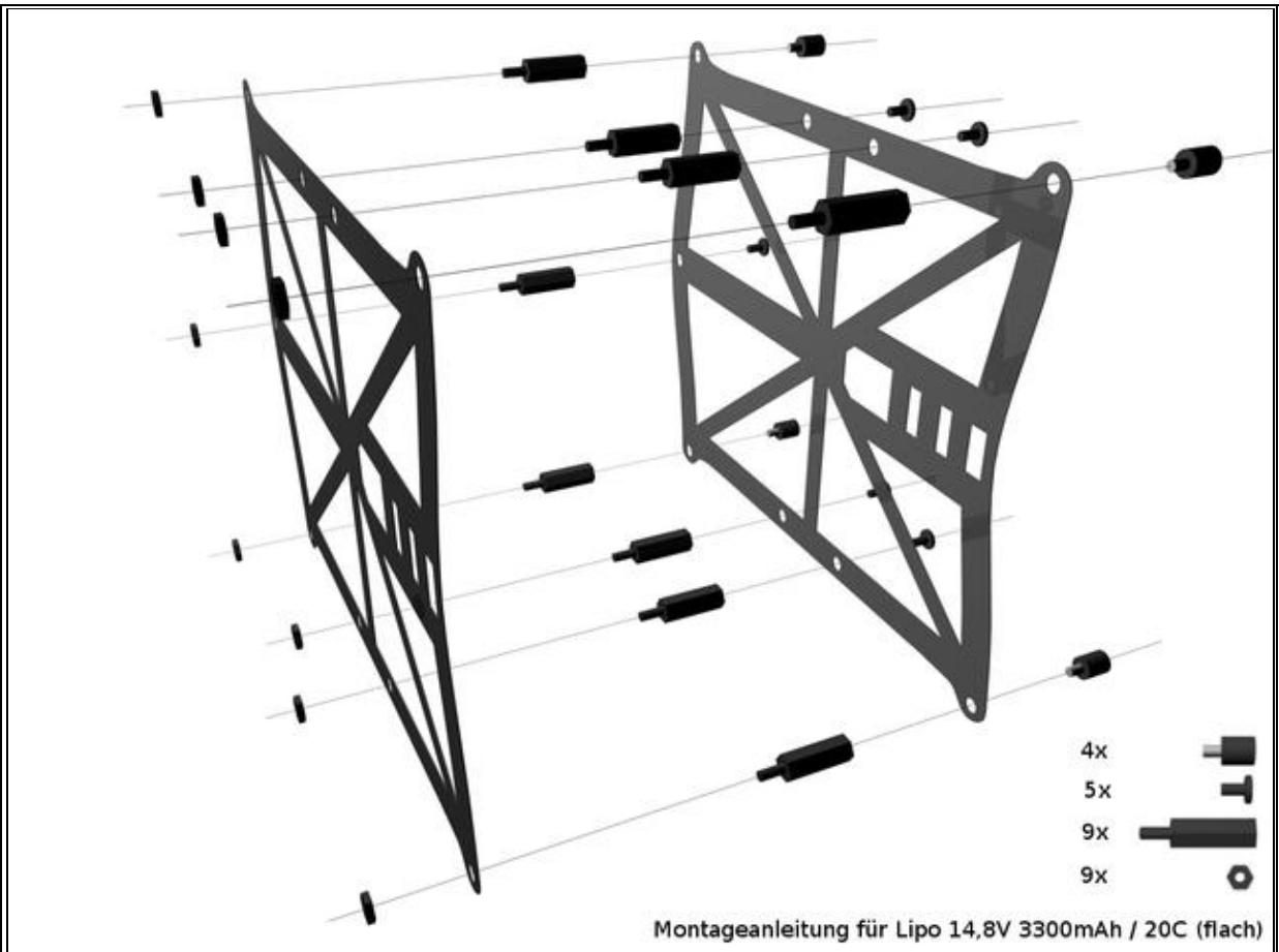
[Beispiel für einen Lipo 14,8V/3300mAh/20C \(flach\)](#)
