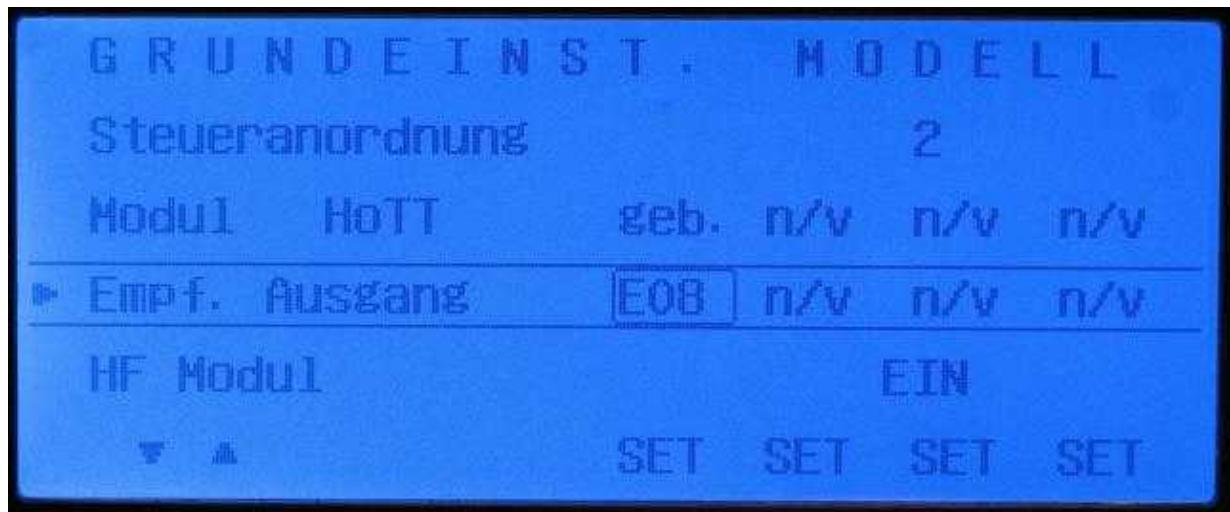
Im sich dann öffnenden Fenster wählt man den ersten Servoausgang *Empf. Ausg 1* aus und stellt diesen mit dem *Empf. Eing. 1* um auf den Kanal 11.
