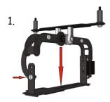
Unterstes Montageloch: Rahmenhöhe: 60 mm Rahmenbreite: 120mm
