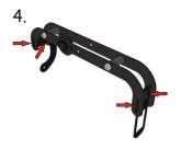
Zur besseren Festigkeit kleben Sie die Rahmenelemente an den gekennzeichneten Stellen zusammen.
