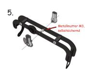
Die Kugelschuhe werden in die mittigen Löcher gesteckt und mit selbstsichernden M3 Muttern von innen angeschraubt. Achten Sie unbedingt darauf, dass sich die Kugelschuhe leicht drehen lassen.
