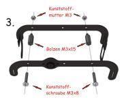
Nun können Sie die vormontierte zweite Rahmenplatte aufschrauben. Nehmen Sie hierzu die entspechenden Kunststoffschrauben und Muttern.
