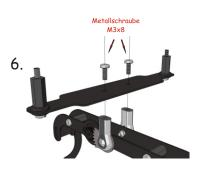
Nun können Sie die Tragplatte auf die Kugelschuhe schrauben. Nehmen Sie hierzu die M3x8 Metallschrauben.
