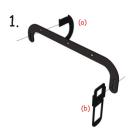
Die gebogene Seitenplatte (a) wird von hinten, und die rechte Servoplatte (b) von vorne eingesteckt.
