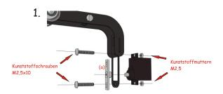
Das Servo wird entsprechend der Zeichnung montiert.
