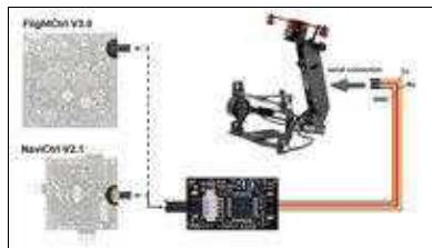
Die GimbalCtrl wird mit dem 4pol Molex-Kabel an den I2C-Bus der FlightCtrl V3 oder dem I2C Bus der NaviCtrl V2.1 angeschlossen.
