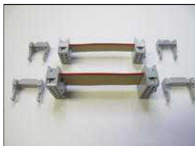
Zum Schluss werden die Pfostenstecker gedreht und die Zugentlastungen aufgesteckt - fertig.
