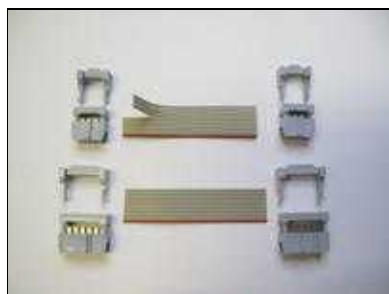
Jetzt kann jeweils an den Enden des Flachbandkabels der Pfostenstecker aufgekrimpt werden. Wer keine Zange hierfür hat, kann auch vorsichtig mit einer kleinen Wasserrohrzange die Stecker quetschen.
