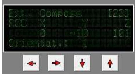
Im virtuellen Display kann man sich die Einbaulage und ACC-Werte anzeigen lassen.
