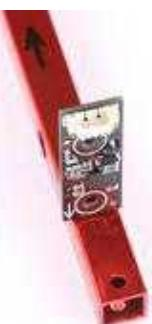
Auch hier muss der Kompass genau gerade montiert werden.
