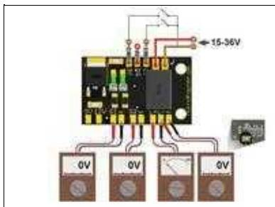
In der Grundeinstellung liegt an den Ausgängen "S1" und S2" keine Spannung an und der Schaltausgang "C+/C-" hat keinen Durchgang.
