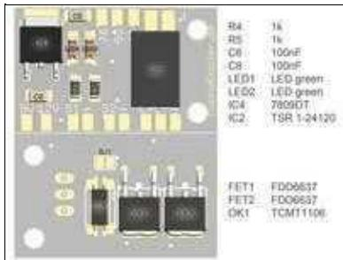
Die Platine muss noch mit den beiliegenden Bauteilen bestückt werden. Benötigt wird hierfür ein geeigneter Lötkolben sowie Grundkenntnisse im Löten.
