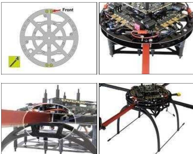
Die 4 langen Metallschrauben M3x20 werden bei dem vorderen und hinteren Ausleger von oben durch die markierten Öffnungen gesteckt (siehe erstes Bild).
