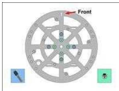
Die 4 Ausleger werden wie auf dem ersten Bild zu sehen ist, (mit dem Motor nach oben zeigend) in die Centerplate (Schrift zeigt nach oben) eingesetzt. Hierbei bitte die Anordnung der Ausleger im ersten Bild beachten.
