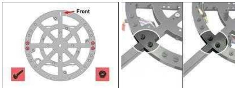
Der linke und der rechte Ausleger werden am Rand der Centerplate mit je 2 Kunststoffschrauben/-muttern fixiert. Der vordere und hintere Ausleger werden später mit einer Metallschraube zusammen mit dem Landegestell befestigt.
