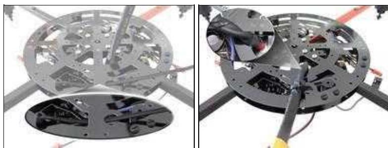
Ist der BL-Verteiler fest montiert, kann das LiPo-Anschlusskabel mit dem Kabelbinder am Rahmen fixiert werden.
