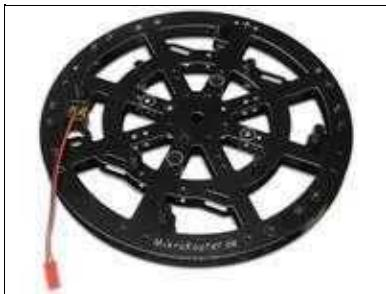
In die fertig vormontierte Centerplate können die vier Ausleger montiert werden.
