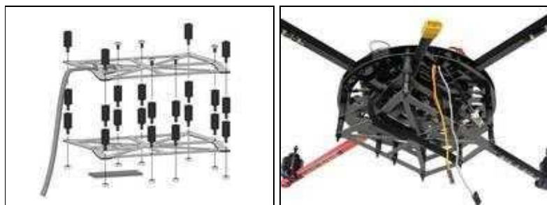
Danach wird der LiPo-Halter unter die Centerplate positioniert und festgeschraubt.
