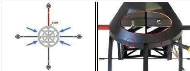
Aufgesetzt wird diese mit den Befestigungslöchern zur linken und rechten Seite.
