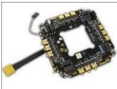
Im nächsten Schritt wird der BL-Verteiler auf dem Rahmen befestigt.
