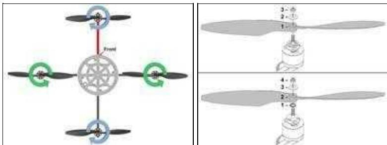
Zum Schluss werden noch die Propeller aufgeschraubt. Hierbei ist die Drehrichtung zu beachten.
