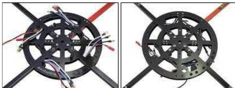
Sind alle 4 Ausleger eingesetzt und verschraubt, sollte das ganze so aussehen.
