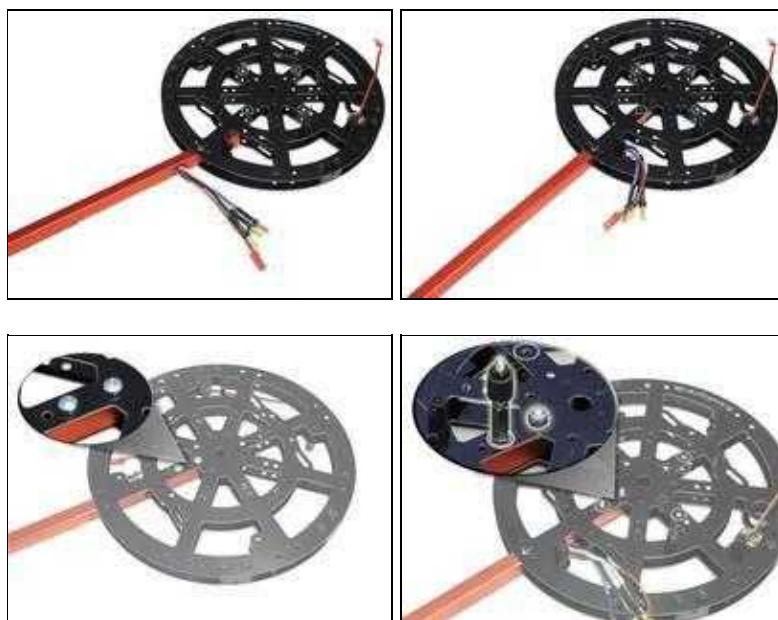
Das Einsetzen der Ausleger sollte vorsichtig passieren um die Motorleitungen nicht zu beschädigen.
