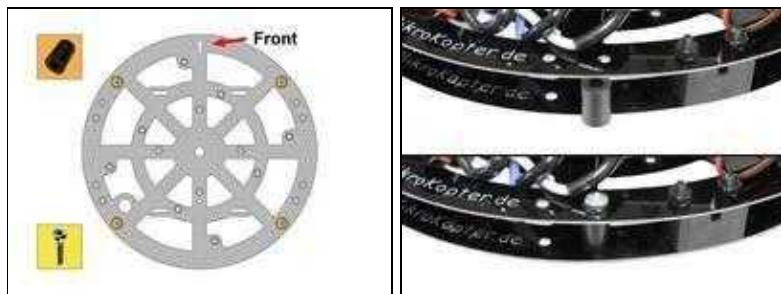
An den im ersten Bild bezeichneten Stellen, werden die 4 Distanzhülsen eingesetzt.
