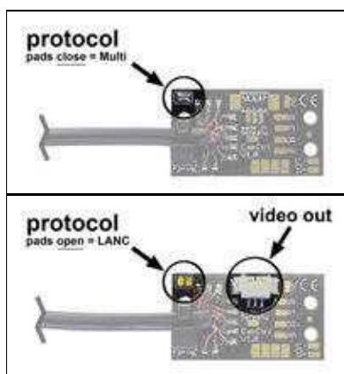
Per Lötjumper kann das benötigte Protokoll auf der *CamCtrl* eingestellt werden.
