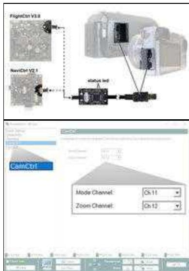
Nutzt man die Version *CamCtrl* "I2C", kann diese direkt an den I2C Anschluss der FlightCtrl V3.0 oder der NaviCtrl V2.1 angeschlossen werden.
