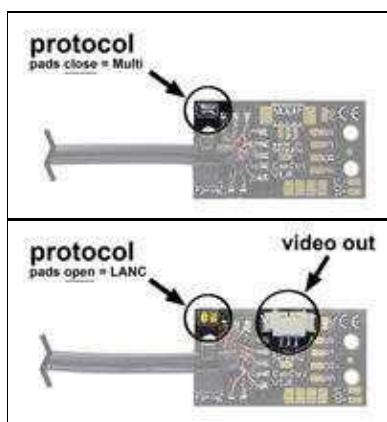
Per Lötfumper kann das benötigte Protokoll auf der *CamCtrl* eingestellt werden.
