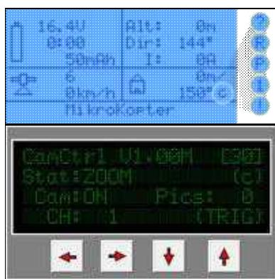
Bei Nutzung über "I2C" wird der jeweilige Status über die Telemetrie übertragen und angezeigt.
