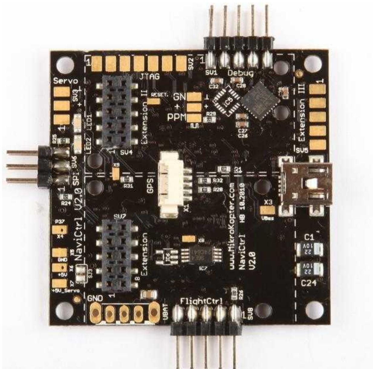
Die **NaviCtrl V2.0 mit integriertem Kompassmodul** ist der Nachfolger der NaviCtrl V1.1 und erweitert in Verbindung mit dem **MKGPS** die Fähigkeiten des MikroKopters.
